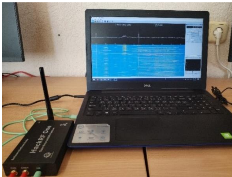
Рисунок 2- Устройство радиомониторинга каналов управления БЛА
