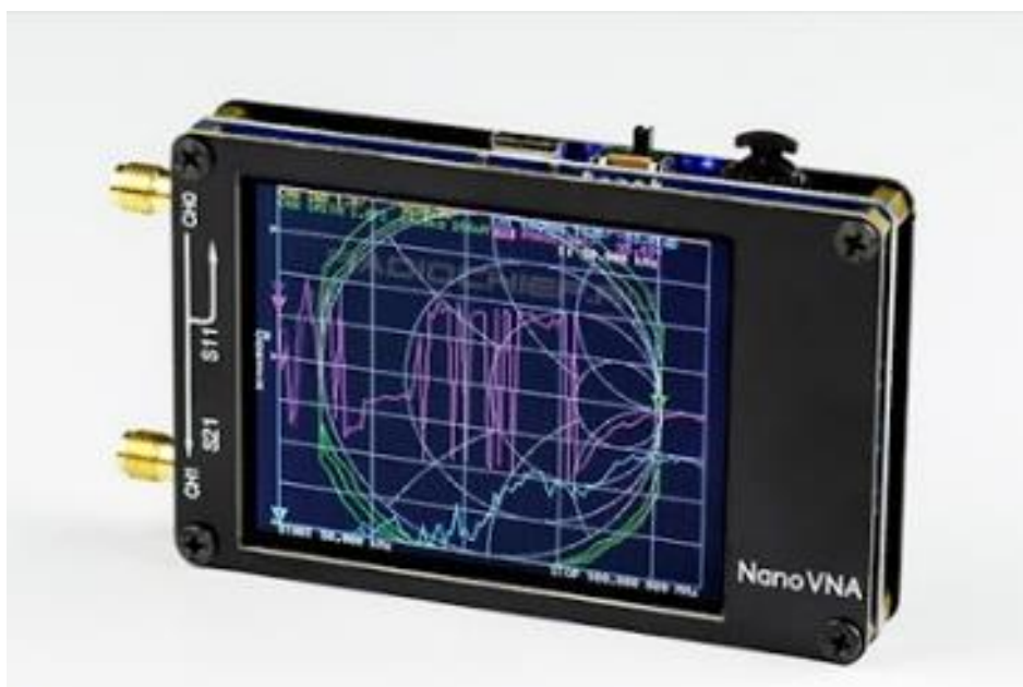
Рисунок 1 – Векторный анализатор NanoVNA
