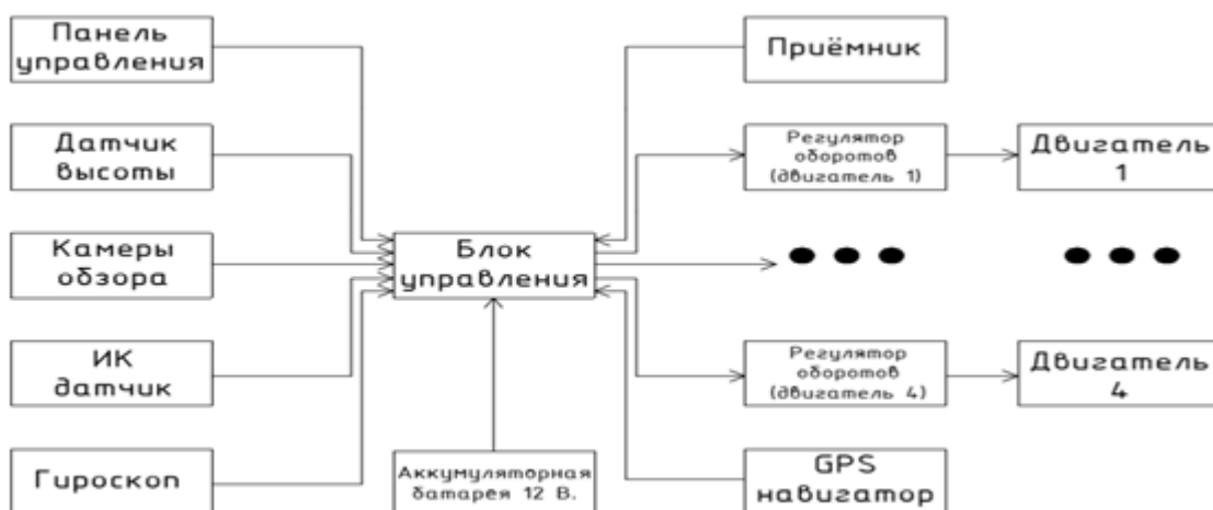
Рисунок 1– Структурная схема управления квадрокоптера
