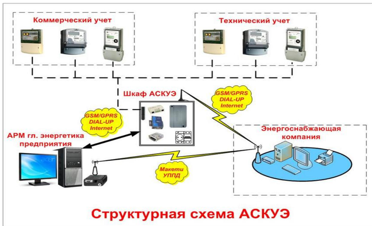
Рисунок 1 – Структурная схема системы АСКУЭ
