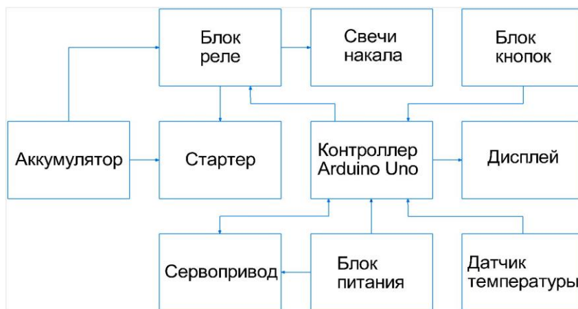
Рисунок 1 – Структурная схема устройства контроля
